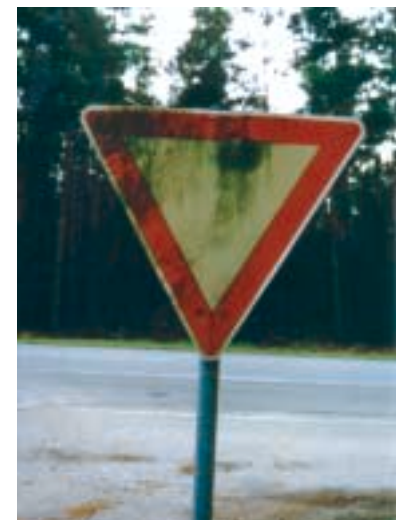
Bild 1: Von Algen befallenes, emailliertes Verkehrszeichen (Bild aus ÖAP-Merkblatt „Algen, Pilze u.a. an Fassaden“)
